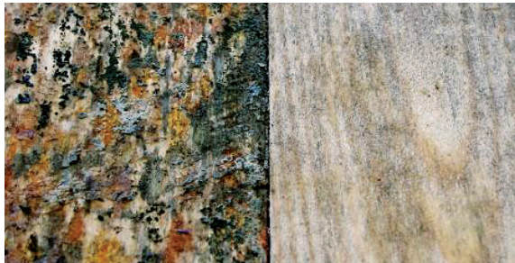
Struktur des Pilzbefalles auf hitzebehandeltem (links) und nicht-hitzebehandeltem (rechts) frischem Kiefernspiltholz nach zweiwöchiger Lagerung unter Folie in sehr feuchtem Klima
